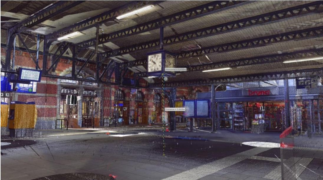
Figuur 8 - Voorbeeld puntenwolk constructie (Geomaat, 2018)
